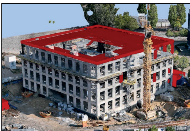
Rys. 4 Śledzenie postępu budowy przy użyciu modeli IFC, platformy CDE (Dalux) oraz chmury punktów
